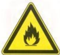
degoša viela vai ugunsbīstama telpa
